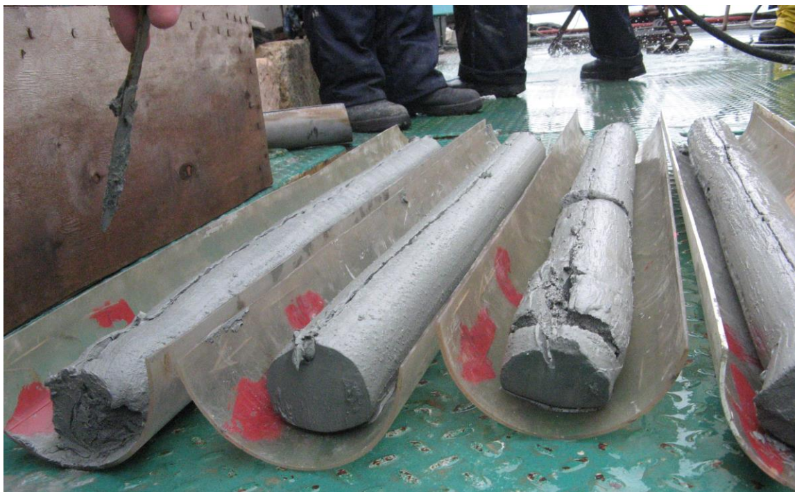
Рисунок 1. Образец керна однородной серо-бурой глины
