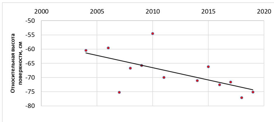
Рисунок 2. Тепловая осадка поверхности наблюдательной площадки с 2004 по 2019 гг.
