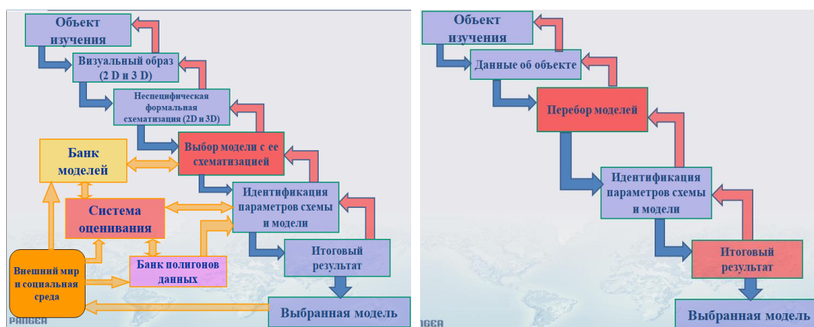
Рисунок.1. Слева (Рис 1а) пример типовой схемы анализа данных без метаанализа и накопления знаний. Справа (Рис 1б) пример схемы моделирования в петрофизике (с петлями накопления и обобщения знаний).
